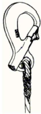
Bild 17: Karabinerhaken mit Einhandbetätigung, die Sicherung wird nach Drehen und Zurückschieben des Sperrbolzens geöffnet
